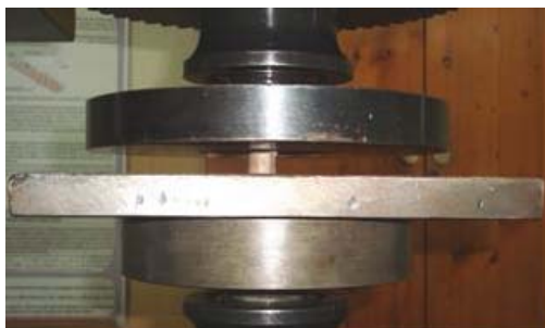
Fig. 2. Muestra ósea de la mitad de la diáfisis de la tibia N° 2 sometida a compresión.
